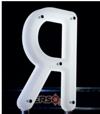
PMMA 30 mm 1 pasada 3.500 mm / min
